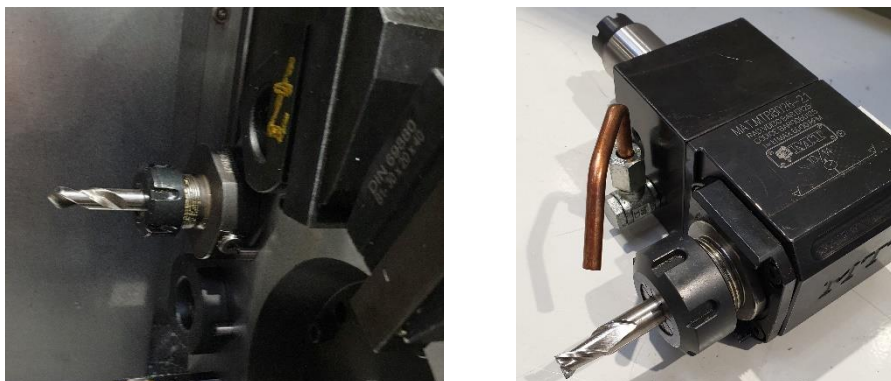
Figure 14 : Foret pour perçage dans l'axe de la broche (gauche), fraise 2 tailles montée sur tourelle (droite)
