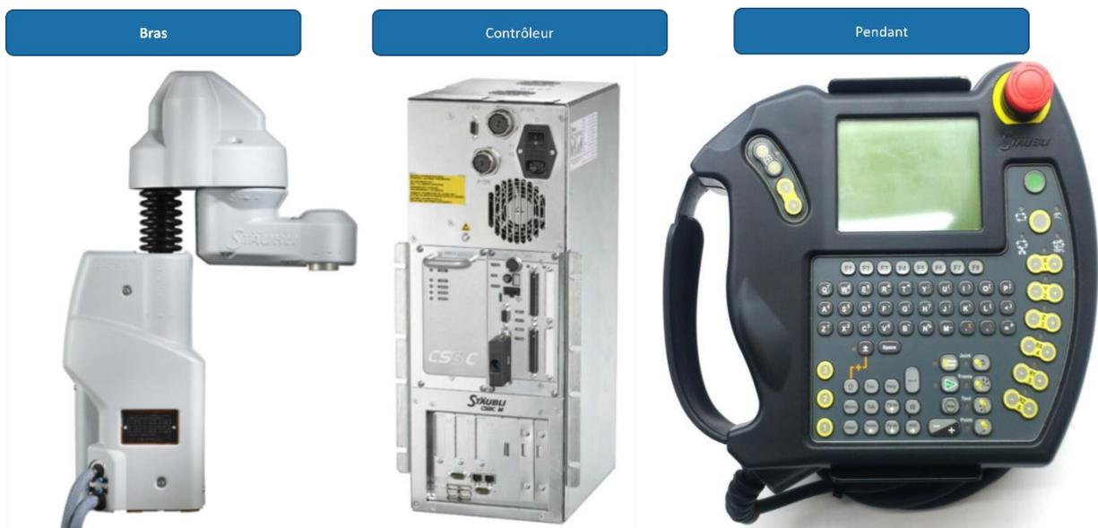
Figure 1 : Système robotisé
