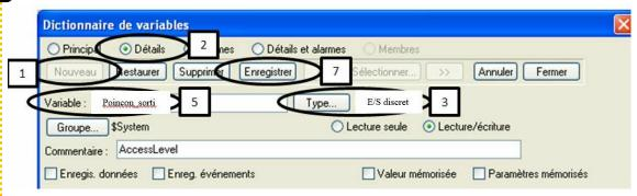
Dans un premier temps on va déclarer une seule variable « Poincon\_sorti » qui est une variable de type E/S Entier et on va l'associer au symbole OPCUA « xCptPoinconBas ». Ce symbole contient les bits à utiliser pour le capteur de position du vérin de poinconnage.
