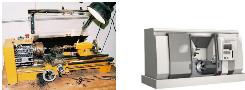
Figure 7 : Tour conventionnel (gauche) et à commande numérique (droite)
