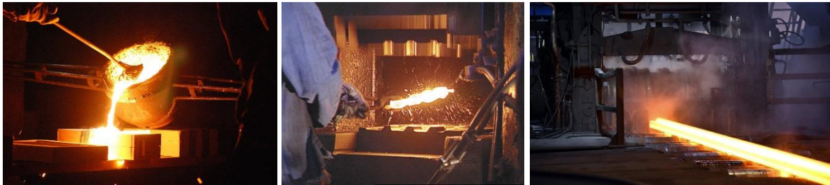
Figure 1 : Procédé d'obtention des bruts, de gauche à droite : Fonderie, forge et laminoir
